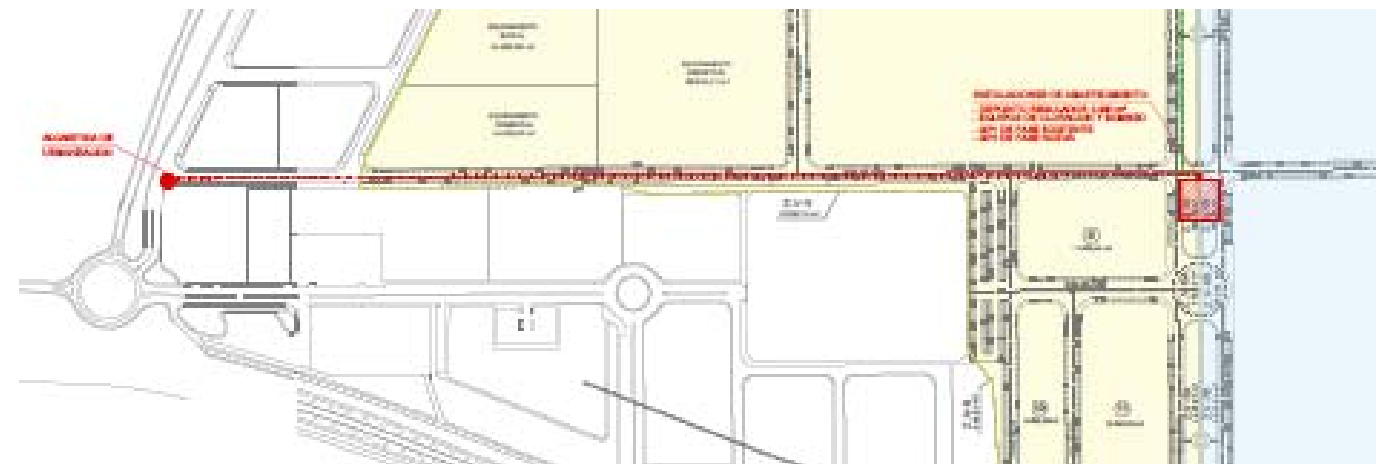
Extracto del Plano de la acometida de abastecimiento al depósito y conexión con la fase existente.
